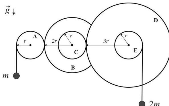
Cinco discos A, B, C, D e E, de centros fixos, giram solidariamente conforme a geometria da figura. Duas partículas de massas  $m$  e  $2m$  enrolam ou desenrolam fios inextensíveis às mesmas velocidades escalares das bordas de seus respectivos discos.
