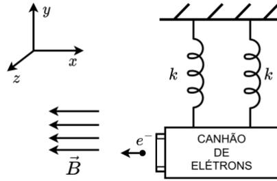
Na figura, é apresentado um canhão oscilando preso ao teto por duas molas e disparando continuamente elétrons numa região sujeita a um campo magnético constante
