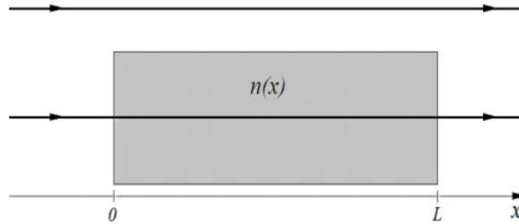
Dois feixes de luz em fase se propagam no vácuo para a direita paralelamente ao eixo  $x$  desenhado na figura. Um dos feixes atravessa um bloco com a forma de um paralelepípedo, em cujo meio o índice de refração é variável, provocando uma diminuição de velocidade e conseqüente atraso no tempo de viagem.
